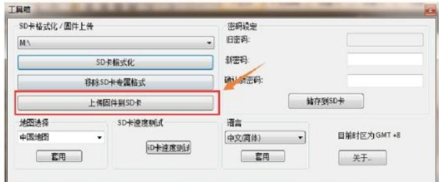
然後拔出TF卡插入到記錄儀，按住VIEW鍵接通12V電源上電開機，進入升級狀態後，放開VIEW鍵，升級完成後，按確認鍵或重新上電，特別註意在提示升級時，不能中途拔卡或斷電，以免造成升級失敗，導致不能開機。
